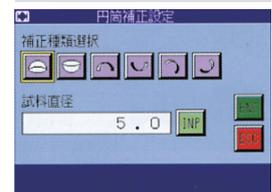
球面・円筒の試験時の補正を設定できます。
