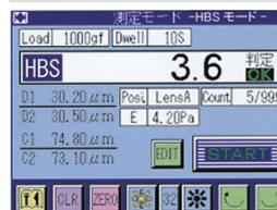
鋼球圧子(オプション)を取り付け、試験力の合うブリネル硬さを試験可能です。
